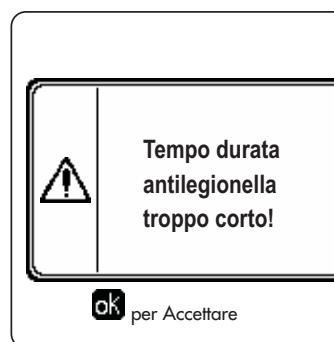
fig. 27 - Messaggio Funzione antilegionella non conclusa
